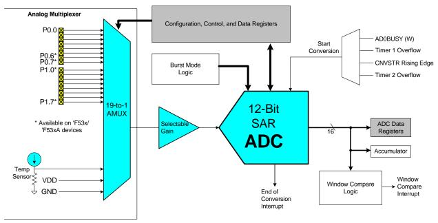
Figure 1.7. 12-Bit ADC Block Diagram
